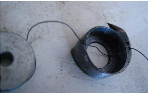
Der Nähfuß muss oben stehen. Drehen Sie die obere Abdeckkappe des Freiarms im rechten Winkel zum Freiarm. Entfernen Sie die Spule und das Spulengehäuse aus der Nähmaschine. Das gelingt am besten, indem Sie diese mit einer Ahle oder einem anderen spitzen Gegenstand durch das Loch am Boden herausdrücken. Führen Sie den Faden auf diese Weise durch die Ösen.
