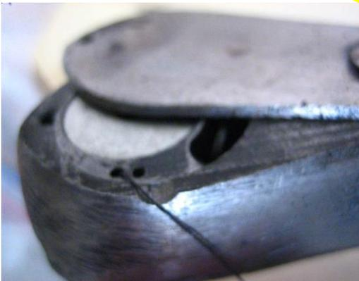
Setzen Sie die Spule und das Spulengehäuse wieder in die Nähmaschine ein. Ziehen Sie den Faden mindestens 10 cm aus der Spule heraus und legen Sie ihn in die Kerbe. Schließen Sie die Abdeckkappe.
