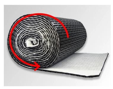
De drainage- en bufferlaag wordt geplaatst met de zwarte kant naar beneden zodat het witte filtervlies bovenaan ligt. Op een plat dak is er altijd wat afloop zodat het regenwater vlot weg loopt naar de waterafvoerpunten. Meestal is deze afloop op een plat dak 1 à 2%. Rol de drainage- en bufferlaag uit in de richting van de afloop.
