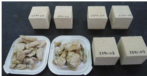
Muestra después de 15 ciclos de ataque de sales Sample after 15 salt attack cycles
